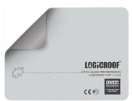
Область применения: ПВХ мембраны LOGICROOF применяются для гидроизоляции однослойных кровельных систем с механическим креплением и свариваются горячим воздухом при помощи автоматического оборудования. Мембраны сохраняют эластичность при низких температурах и применяются во всех климатических районах согласно СНиП 23-01-99. Запрещен прямой контакт со всеми материалами содержащими битум и растворители, а также с вспененными утеплителями (EPS, XPS, PIR, пеностекло).
