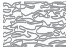
Ламинарная структура (волокна уложены горизонтально)
